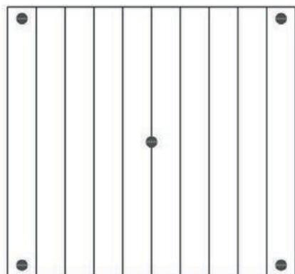
Para ajudar na ancoragem da peça no teto é recomendado alternar a cada 40cm com fita dupla face, pedaços de 10cm, junto com a cola de PU de agarre imediato.
